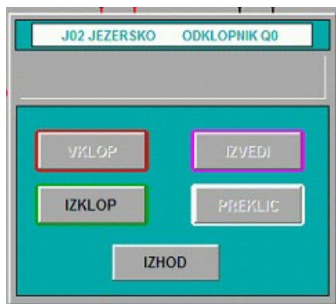
Slika 5: Princip organizacije okna za izvajanje stikalnih manipulacij
